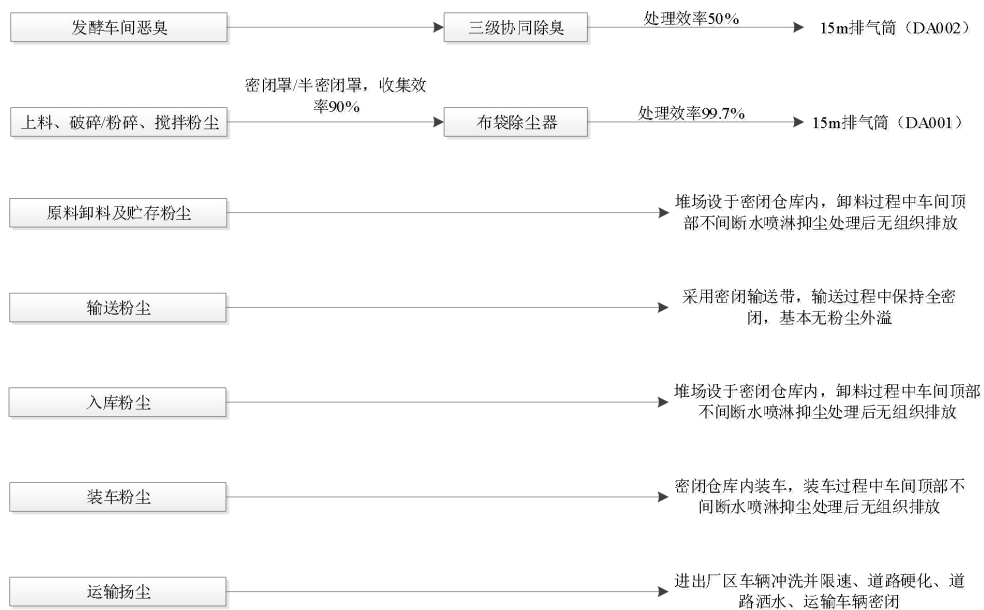
图 4-1 本项目废气收集和治理示意图
