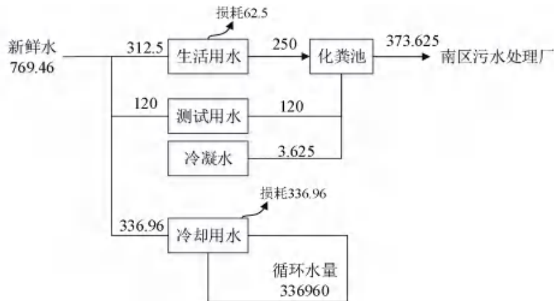
图 2-1 本项目水平衡图 (t/a)
