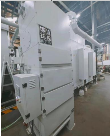
机加工油雾收集净化装置
