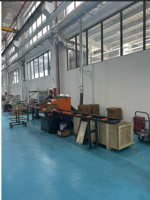
砂轮切割集气罩（收集后进入布袋除尘器）
