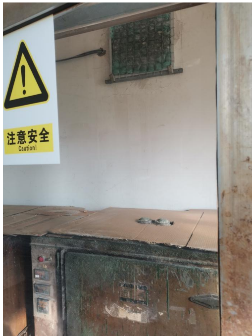
烘干废气密闭负压收集
