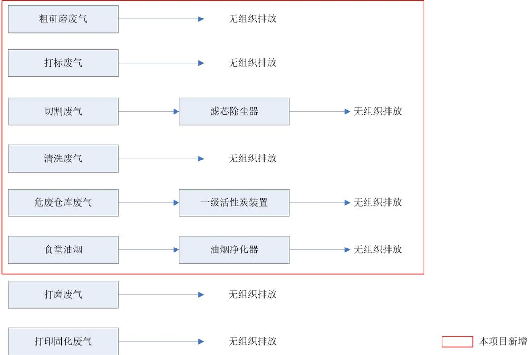
图 4-1 全厂废气收集处理示意图
