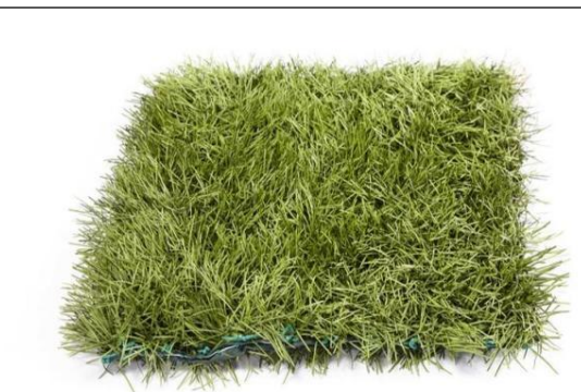
针叶型多频吸波材料
