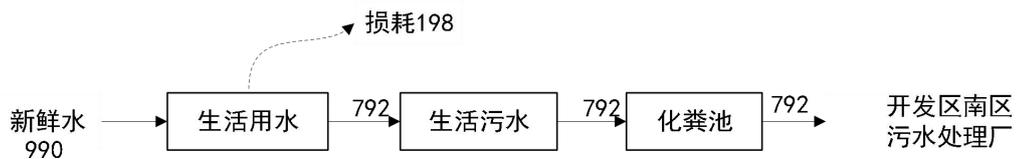
图 2-1 本项目水平衡图 (单位: t/a)
