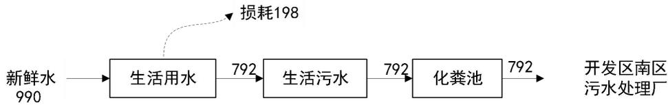
图 4-2 本项目水平衡图（单位：t/a）
